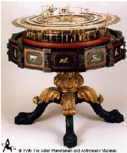
Figura 6.- Un gran planetario, de aproximadamente 39 pulgadas de diámetro, construido por Thomas Heath en Londres en 1740. Luego del descubrimiento de Urano en 1781, el propietario añadió el anillo más externo para mostrar el nuevo planeta.
