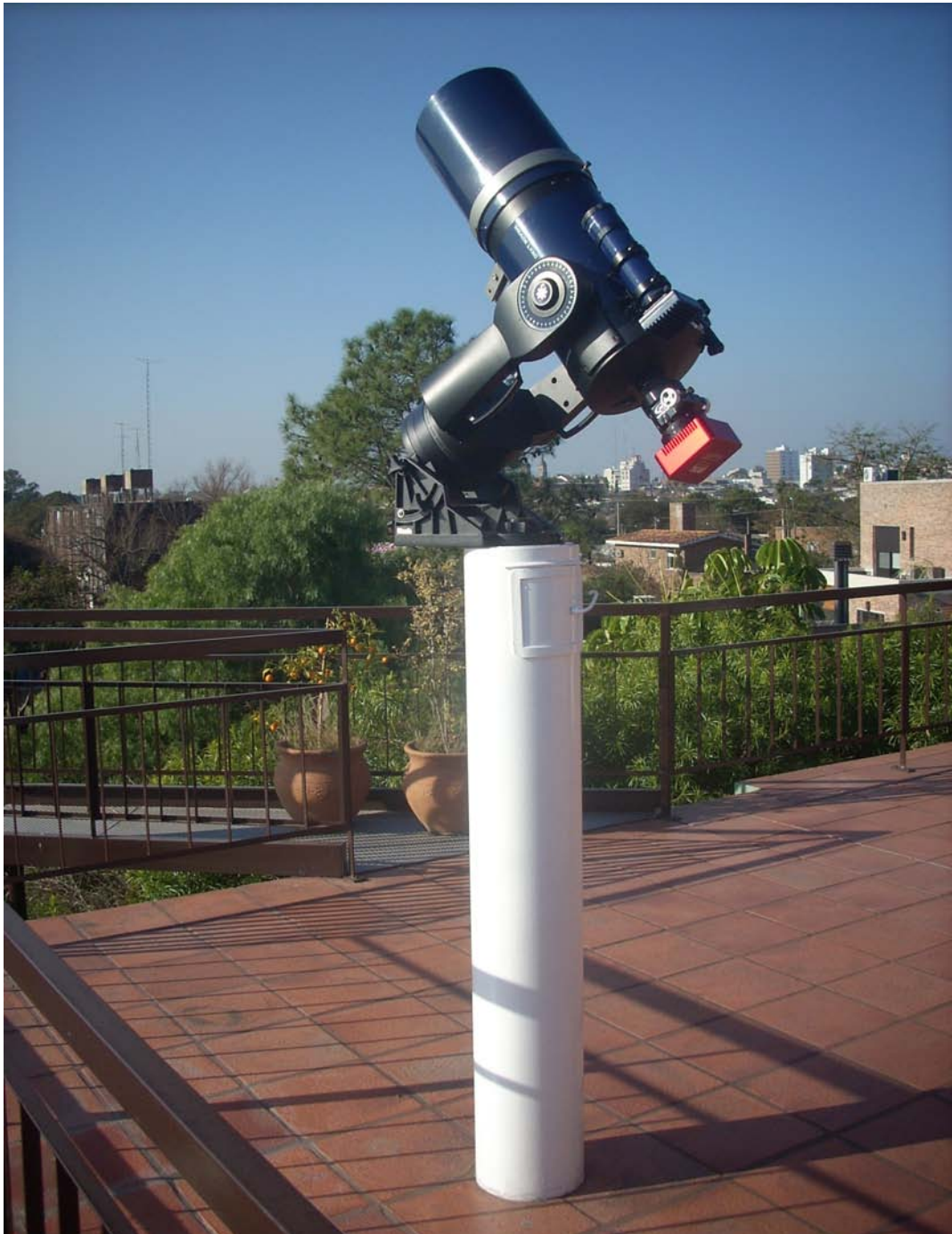
Fig. 3: Telescopio Schmidt-Cassegrain (Meade LX-90) de 20 cm.
