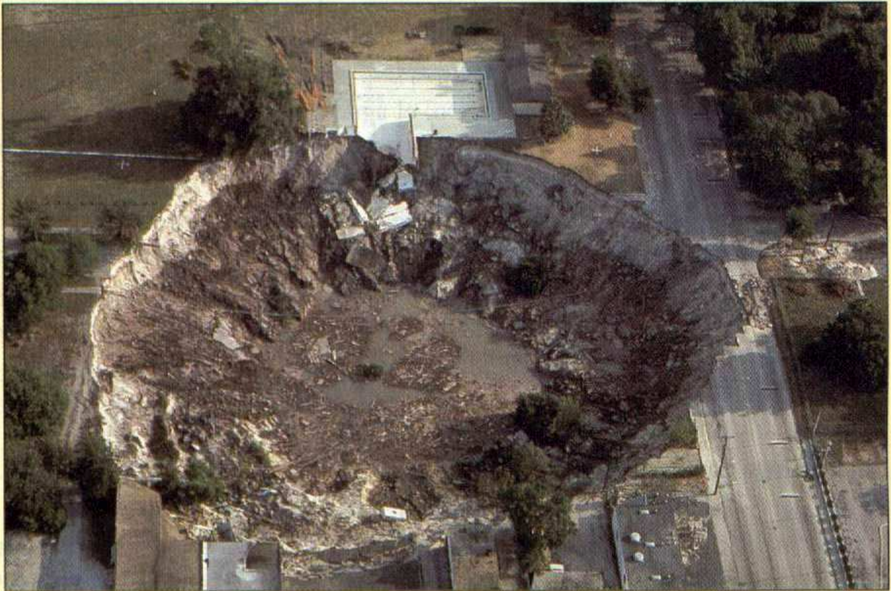
Figura 11.C Una dolina de Florida que creció rápidamente durante tres días, tragándose parte de una piscina comunitaria, así como varios comercios, casas y automóviles.
