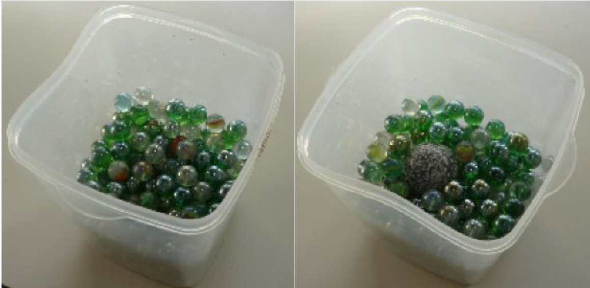
Fig. 2.1.1 Caja con bolitas de diferente tamaño que se hace sacudir para ver el proceso de segregación por tamaño. Tal efecto se conoce como Efecto de las Nueces de Brasil.
