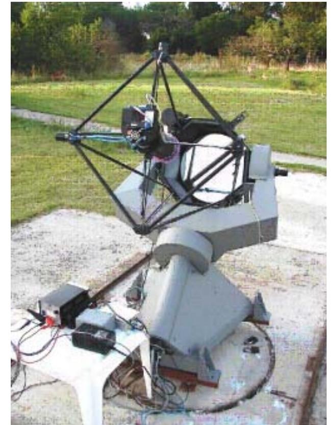
*Fig. 3 : El telescopio reflector Centurion de 46-cm de apertura instalado en el predio del Observatorio Astronómico de Los Molinos (Foto cortesía G. Tancredi).*
