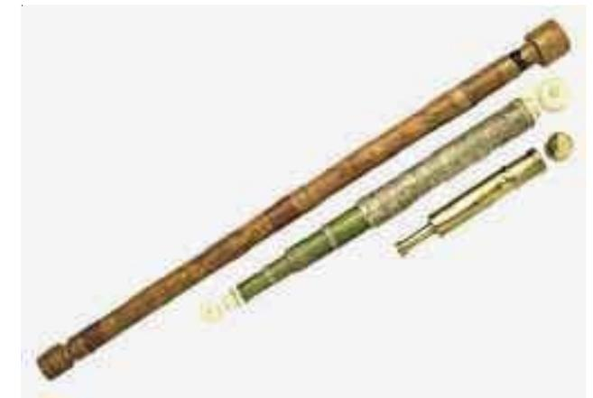
*Esquema del funcionamiento óptico del telescopio refractor galileano con una lente objetivo biconvexa y una lente ocular bicóncava que da una imagen ampliada y derecha (panel superior), y varios de los telescopios rudimentarios construidos por Galileo (panel inferior).*
