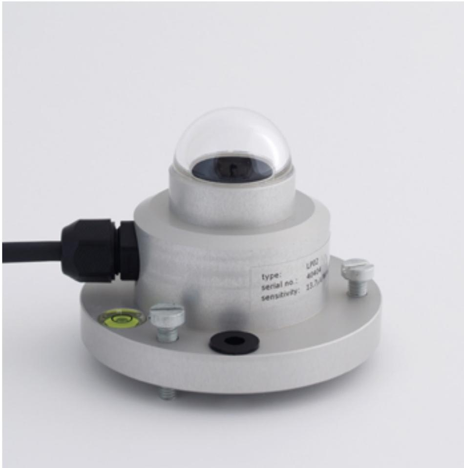
Se utilizan diferentes instrumentos como el *piranómetro* que mide la radiación solar global (difusa y directa). El instrumento utiliza un termopar sobre el que incide la radiación, se genera una tensión eléctrica que es la que se mide. El *pirheliómetro* mide en cambio sólo la radiación directa del Sol, y el instrumento debe estar orientado permanentemente hacia el Sol.
